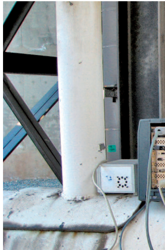
Ein SGS-Experte überprüft die Struktur eines Stahlrohrs (in einem Gebäude in Südkorea), um nach möglicherweise darin enthaltenem Wasserstoff zu suchen, der eine potenzielle Gefahrenquelle darstellt. Die Ultraschall-daten werden in digitale Bilder umgewandelt, durch die eventuelle Mängel erkannt werden können.
