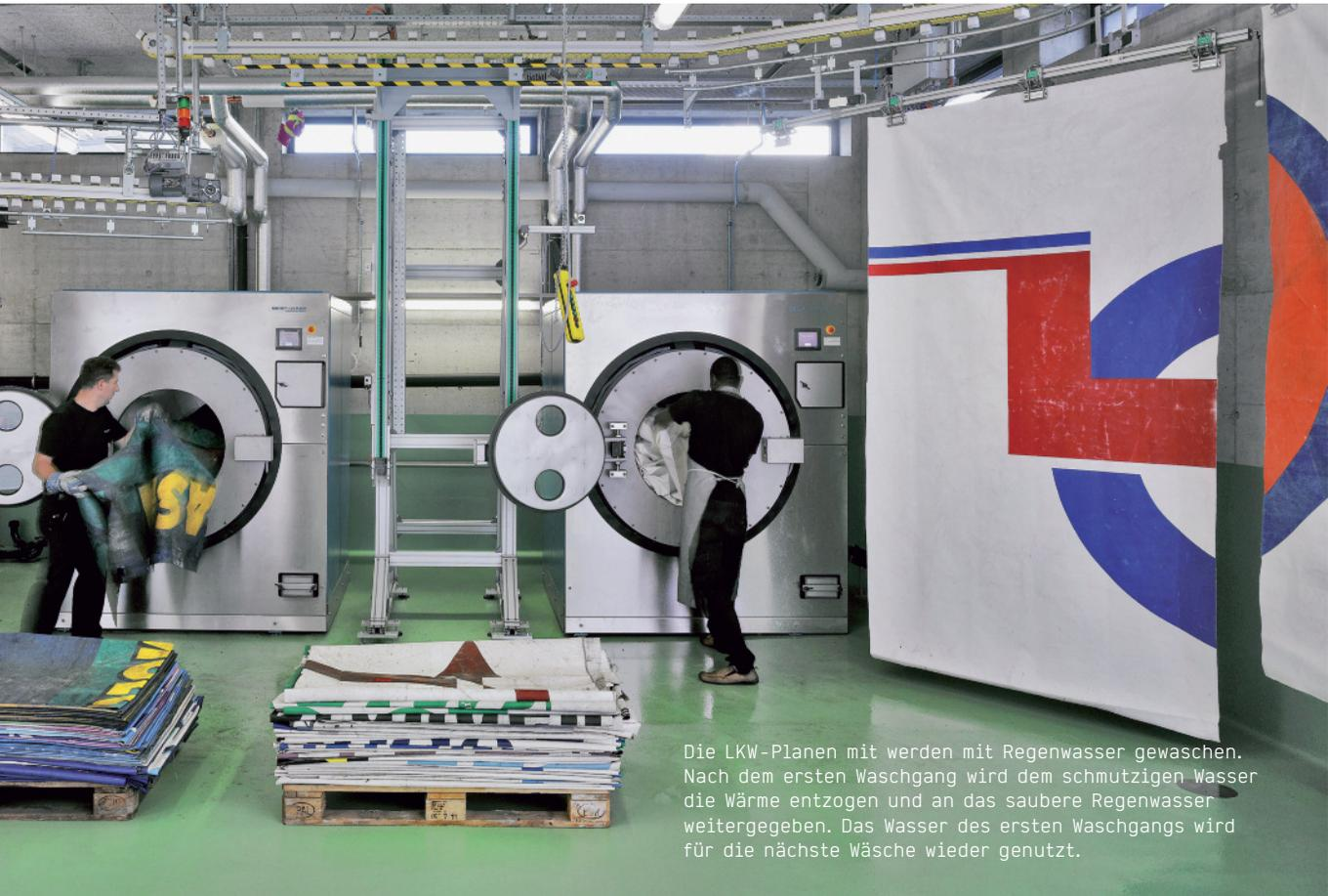
Die LKW-Planen mit werden mit Regenwasser gewaschen. Nach dem ersten Waschgang wird dem schmutzigen Wasser die Wärme entzogen und an das saubere Regenwasser weitergegeben. Das Wasser des ersten Waschgangs wird für die nächste Wäsche wieder genutzt.
