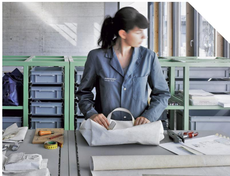
Die ersten Prototypen werden aus weisser Plane gefertigt, damit der Schnitt eines neuen Modells unabhängig von der Taschenfarbe und ihrem Aufdruck begutachtet werden kann.
