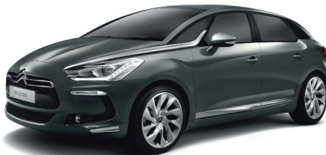
Technisch bietet der Citroën DS5 Hybrid4 exakt die gleiche Lösung wie der Peugeot. Wie bei seinem Cousin aus Sochaux ist der Elektromotor mit 37 PS in die Hinterachse integriert und wird vorne durch den 2,0-Liter-HDi des PSA-Konzerns ergänzt. Das neue Modell von Citroën, der im September an der Internationalen
