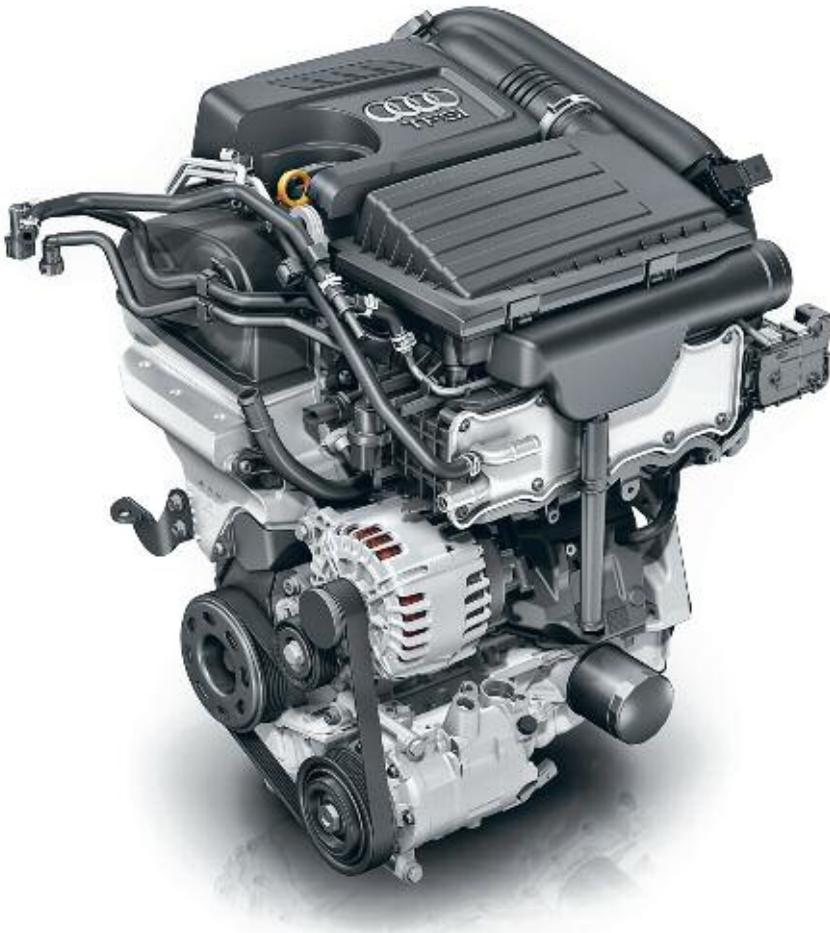
Der 1,4-Liter-TFSI-Motor des Audi A1 ist seit Neuestem mit der sogenannten Cylinder-on-demand-Technologie ausgestattet. Dabei werden im Teillastbetrieb zwei der vier Zylinder automatisch abgeschaltet, um Treibstoff zu sparen.
