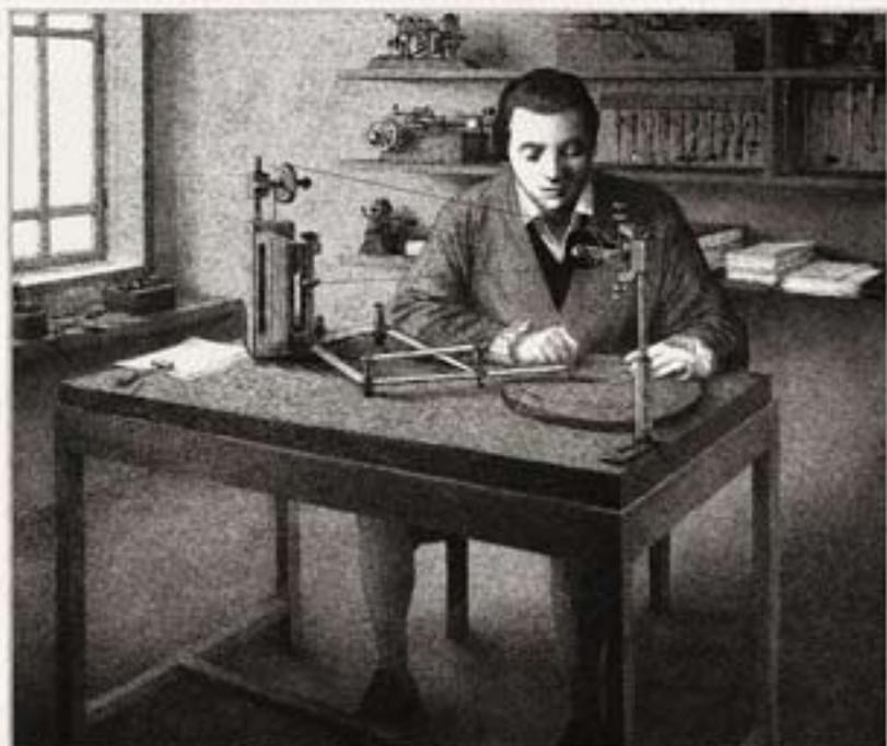
1839 entwickelte Vacheron Constantin zahlreiche Maschinen, darunter auch den berühmten Pantographen. Dieses mechanische Werkzeug ermöglichte zum ersten Mal in der Geschichte der Uhrmacherskunst die perfekte Reproduktion von Uhrenbestandteilen. Hierdurch wurde die Qualität der Zeitmesser erheblich verbessert. Diese Erfindung läutete die Zukunft der Marke ein und revolutionierte gleichzeitig die gesamte Schweizer Uhrmacherskunst.
