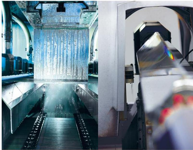
Diese Maschinen von Meyer Burger kalibrieren die Silizium-Ingots und schneiden sie danach in feine Lamellen, die in den Solarzellen zum Einsatz kommen.
