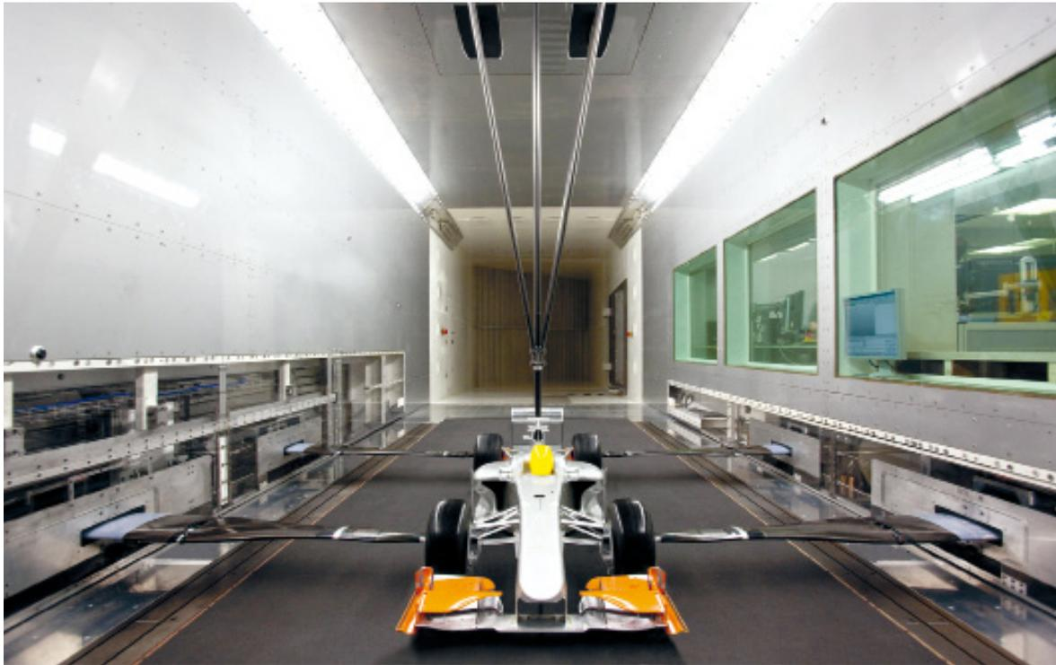
Un essai en soufflerie d'une maquette de la Lotus F1. Grâce à l'impression de pièces en 3D, il devient beaucoup plus simple et rapide de tester différentes solutions techniques.
