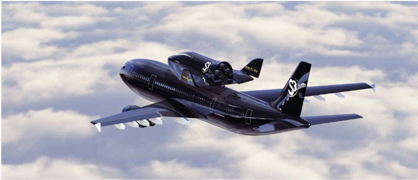
Huckepackverfahren: Das Shuttle wird nach den Plänen von S3 auf dem Rücken eines Airbus A300 zehn Kilometer in die Lüfte befördert.
