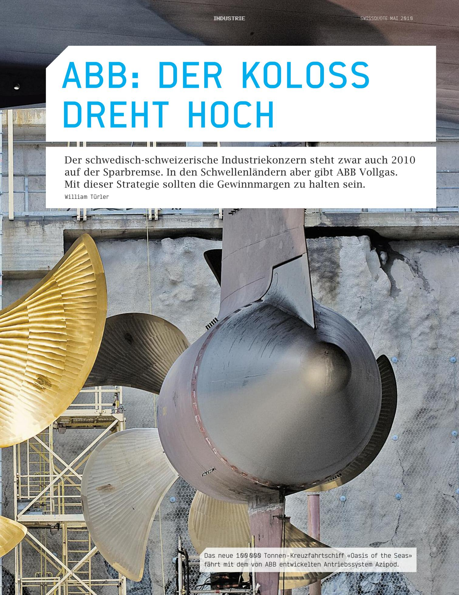
Das neue 100 000 Tonnen-Kreuzfahrtschiff «Oasis of the Seas» fährt mit dem von ABB entwickelten Antriebssystem Azipod.
