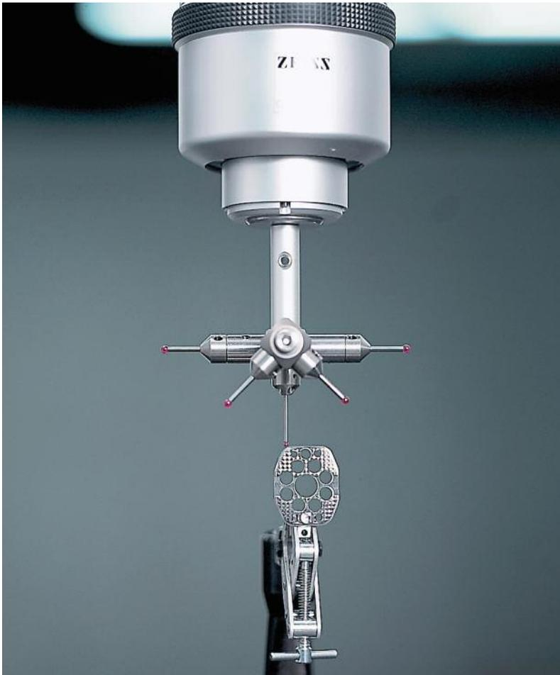
Dieses Gerät wird in den Herstellerfirmen von Synthes eingesetzt, um zu überprüfen, ob die angefertigten Produkte den Spezifizierungen entsprechen.
