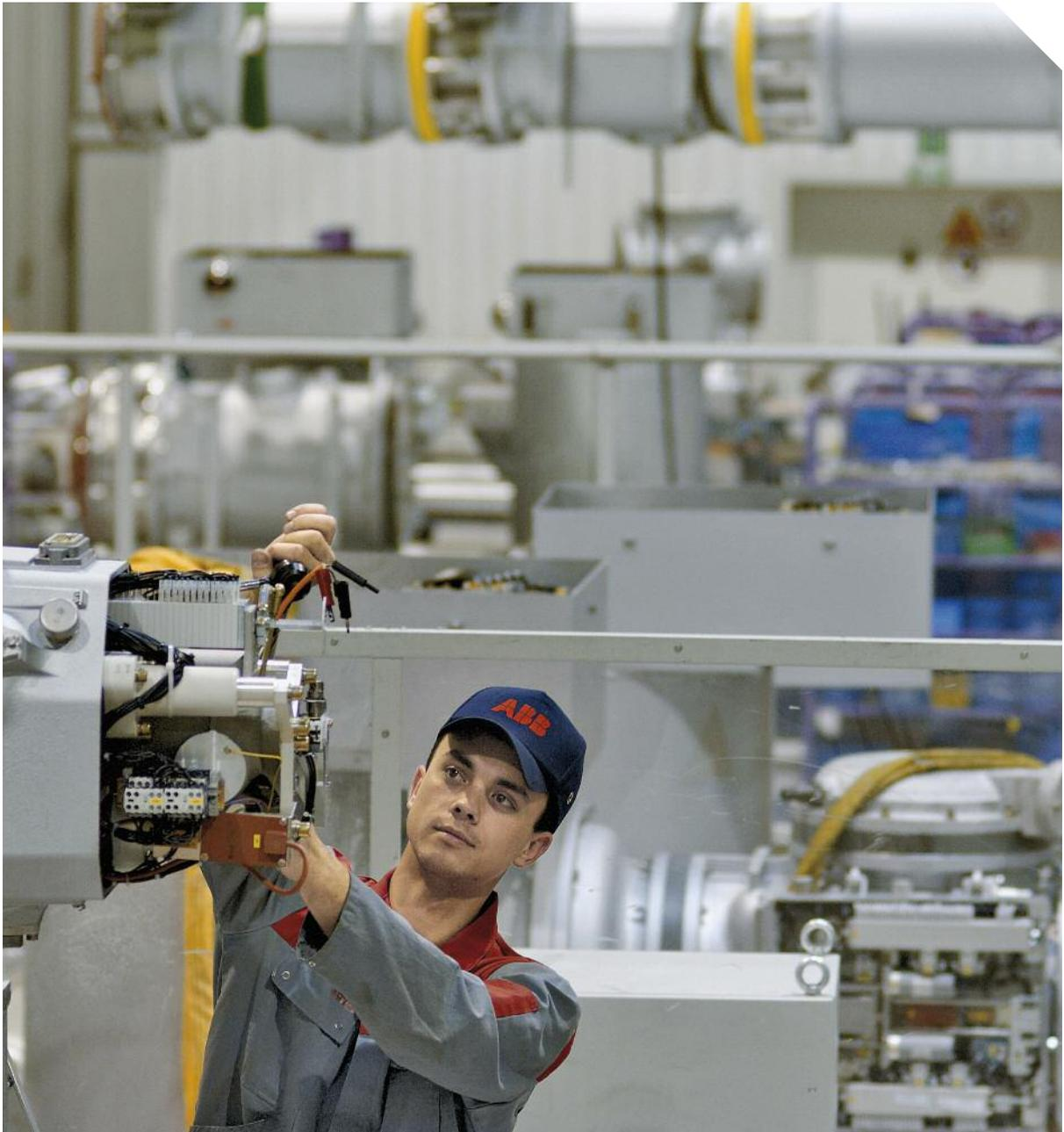
Im deutschen ABB-Werk in Hanau werden Schaltanlagen für Kraftwerke gefertigt.
