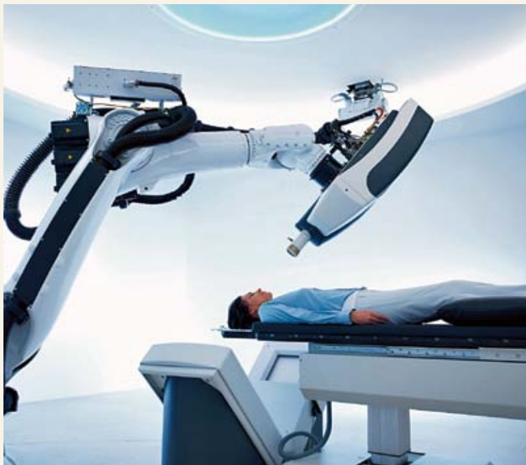
Der höchst präzise arbeitende Roboter Cyberknife von Kuka wird bei der Behandlung von Tumorkranken eingesetzt.
