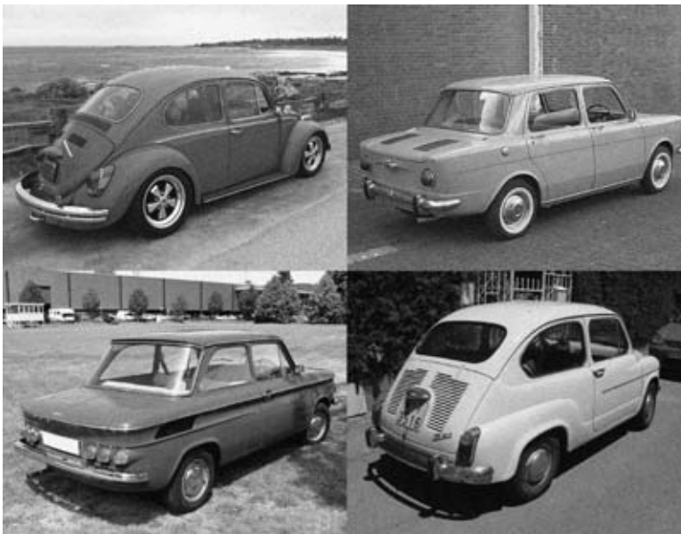
Der Heckmotor hatte seine Sternstunden, bevor er ab den 70er-Jahren nach und nach in Vergessenheit geriet – mit der rühmlichen Ausnahme des sportlichen Porsche 911, der bis heute damit ausgestattet ist. Der VW Käfer, der Simca 1000, der NSU Prinz und der Fiat 600 (oben) wurden zu ihrer Zeit wegen ihres guten Fahrverhaltens auf Schnee im Vergleich zum klassischen Antrieb mit Frontmotor geschätzt.
