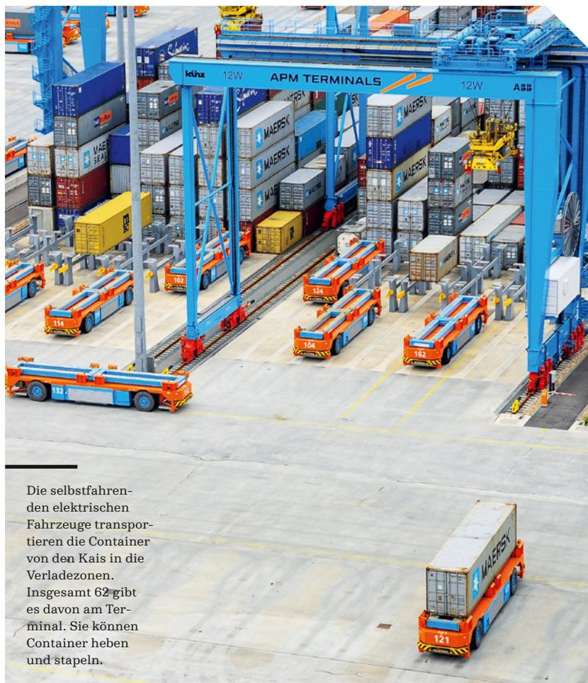
Die selbstfahrenden elektrischen Fahrzeuge transportieren die Container von den Kais in die Verladezonen. Insgesamt 62 gibt es davon am Terminal. Sie können Container heben und stapeln.
