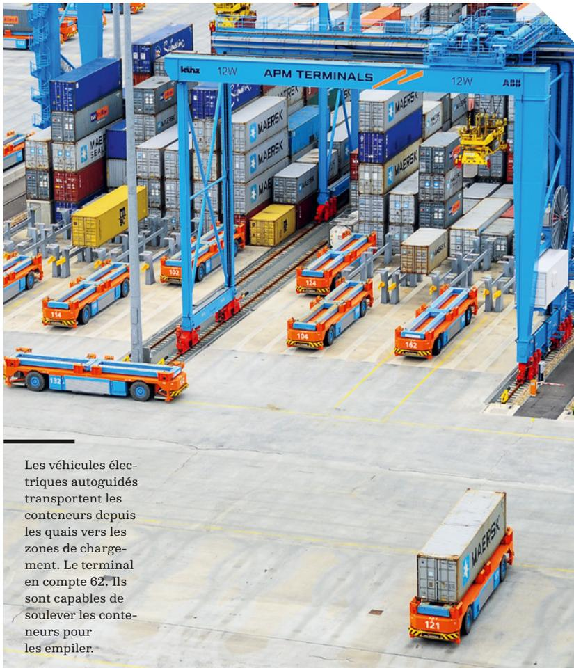
Les véhicules électriques autoguidés transportent les conteneurs depuis les quais vers les zones de chargement. Le terminal en compte 62. Ils sont capables de soulever les conteneurs pour les empiler.
