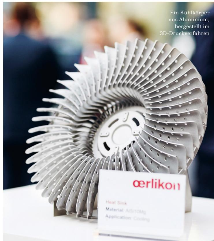
Ein Kühlkörper aus Aluminium, hergestellt im 3D-Druckverfahren
