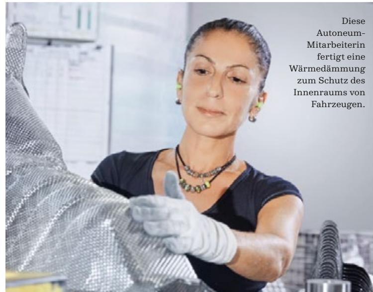
Diese Autoneum-Mitarbeiterin fertigt eine Wärmedämmung zum Schutz des Innenraums von Fahrzeugen.
