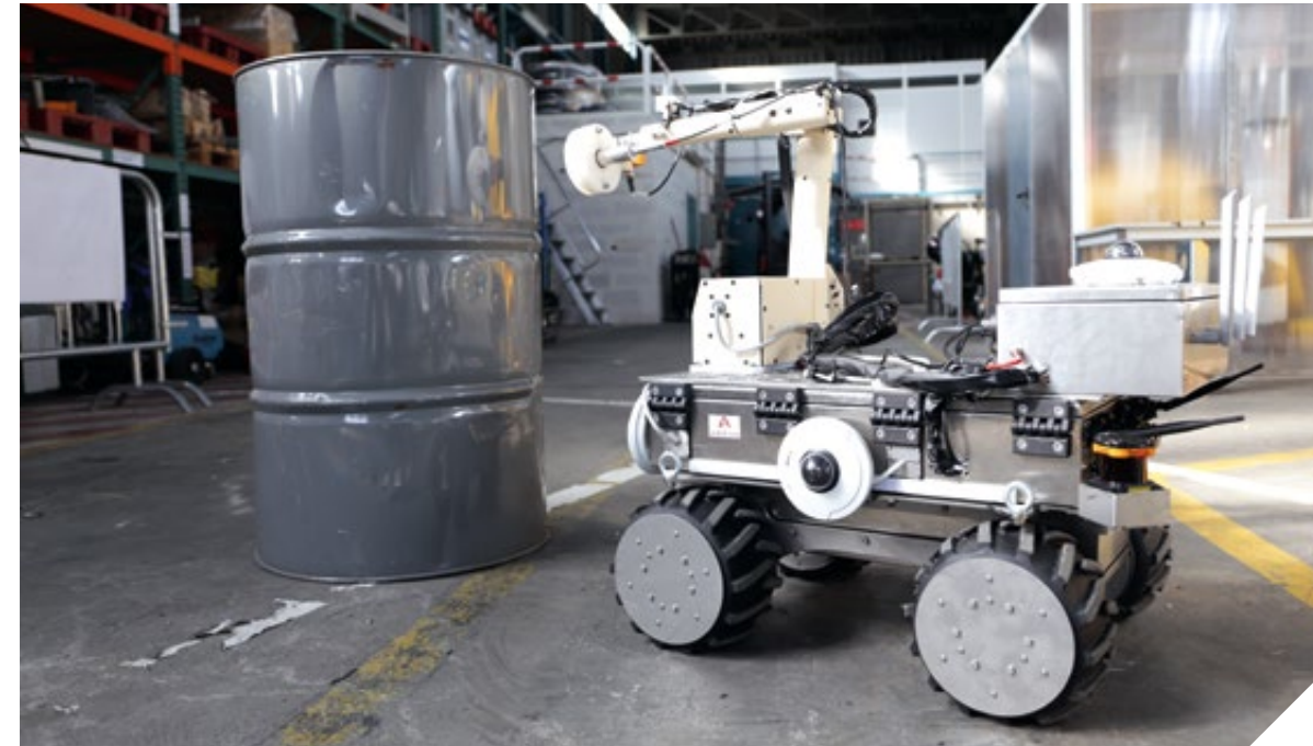
Dieser ferngesteuerte Roboter von Orano wird in radioaktivem Umfeld eingesetzt.
