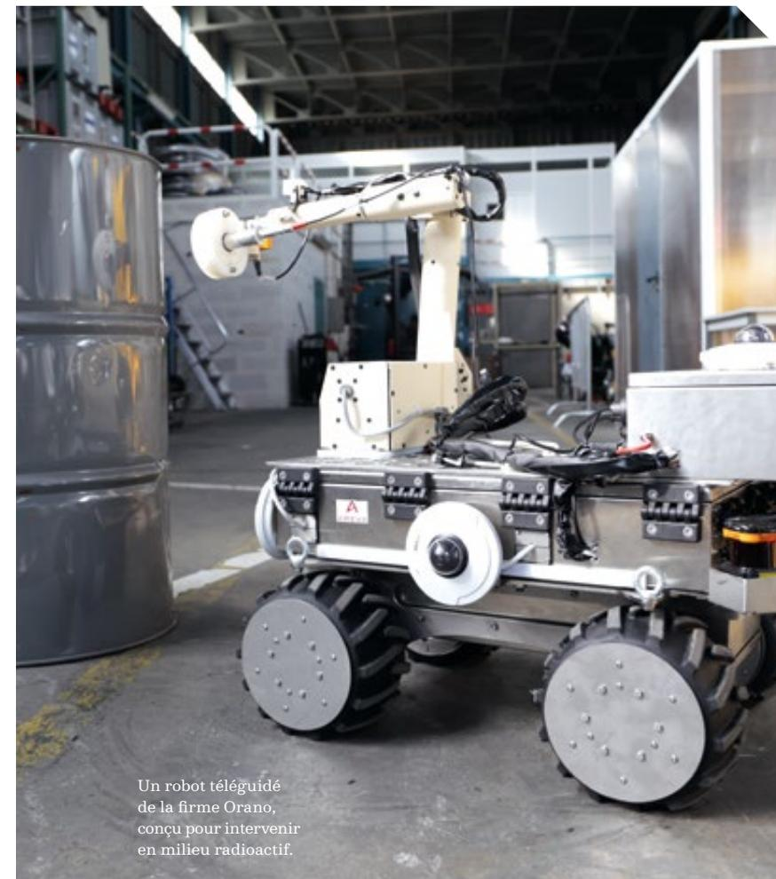
Un robot téléopéré de la firme Orano, conçu pour intervenir en milieu radioactif.
