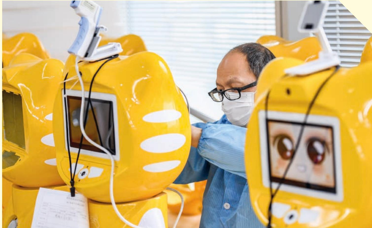
Un technicien assemble un « robot médical », le 11 mars dans la province de Hunan en Chine. Capables de prendre la température, d'enregistrer les données de santé et d'effectuer une désinfection des mains, ces machines ont contribué à soulager les équipes médicales et à réduire les coûts de main d'œuvre dans la lutte contre le Covid-19.
