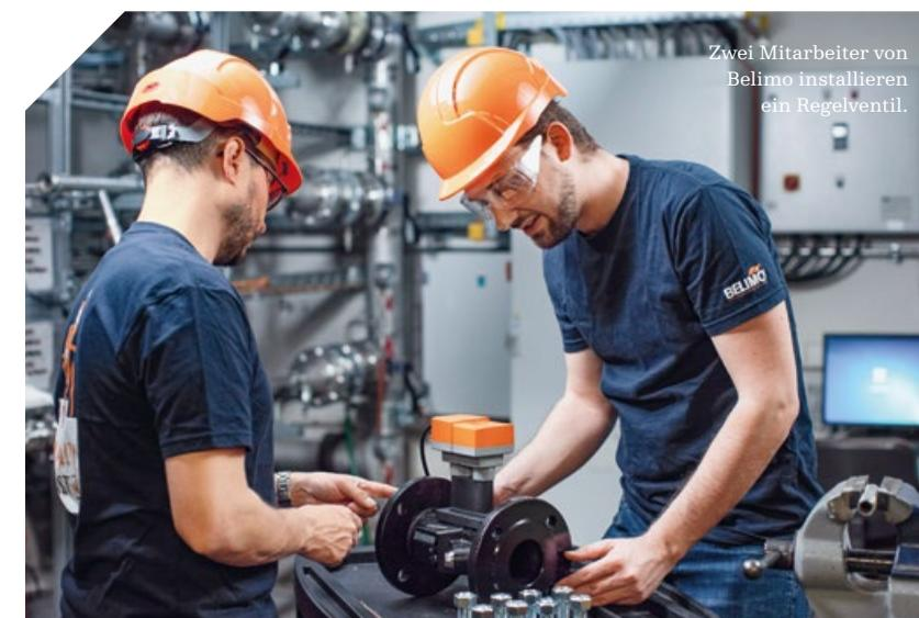
Zwei Mitarbeiter von Belimo installieren ein Regelventil.
