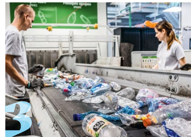
← Sortierband in einer Recyclinganlage für Hausmüll in Mornac, Frankreich
