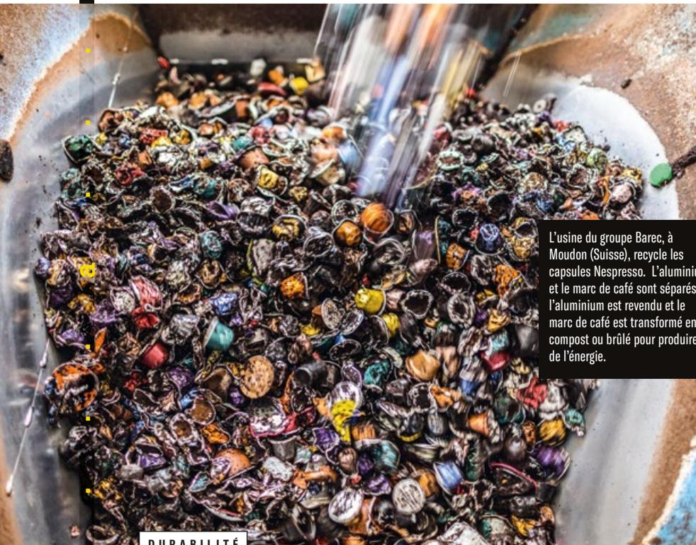
L'usine du groupe Barec, à Moudon (Suisse), recycle les capsules Nespresso. L'aluminium et le marc de café sont séparés: l'aluminium est revendu et le marc de café est transformé en compost ou brûlé pour produire de l'énergie.
