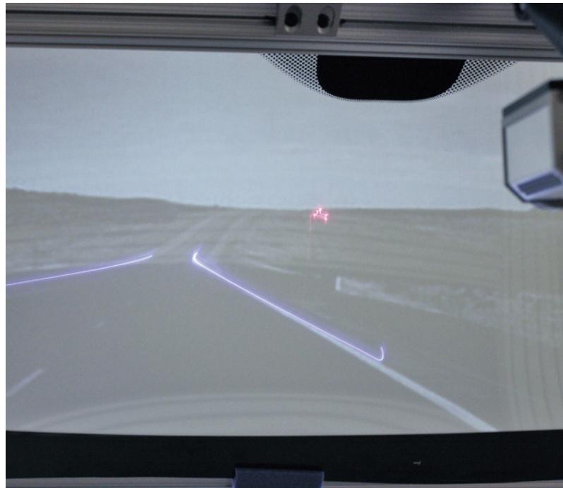
Der Prototyp des neuen HUD-Systems von General Motors zeichnet die Fahrbahn bei schlechter Sicht farbig nach. Mögliche Markteinführung ab 2015.
