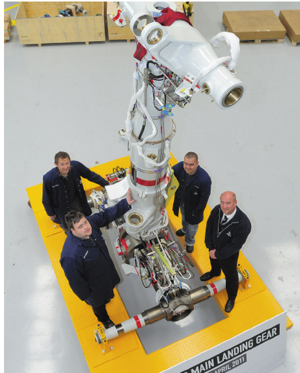
Airbus-Ingenieure arbeiten an der A350-900 – hier das Fahrgerüst –, die ab 2013 ausgeliefert werden soll. Die Maschine soll zu 52 Prozent aus Verbundwerkstoffen bestehen
