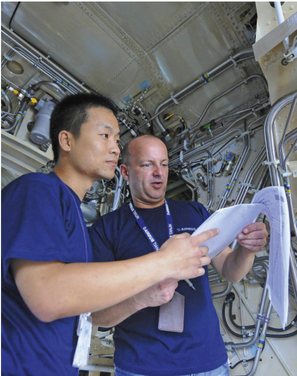
Airbus-Ingenieure arbeiten an der A350-900 – hier das Fahrgerüst –, die ab 2013 ausgeliefert werden soll. Die Maschine soll zu 52 Prozent aus Verbundwerkstoffen bestehen
